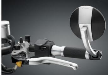
Die Spiegel Spirit sind die konsequente Weiterentwicklung der Spiegel Class Retro. Der neue Haltemechanismus wird außen in die Lenker eingesteckt und verklemmt wie ein Lenkerende. Daher ist die Montage an nahezu jedem Lenker möglich. Eine Verwendung von zusätzlichen
