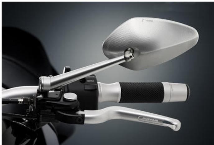
Wunderschöner 3D-gefräster Aluspiegel. Das bläuliche Glas ist konvex geformt und mit einer Größe von 144mm x 89mm auch ABE konform. Die Spiegel werden mittels Adaptern an die Lenkerhalterung montiert. Diese müssen separat bestellt werden.
