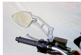
340Gramm. Die Haltearme, wie auch die Spiegelaufnahme, sind hochwertig gefräst. Sie sind in alle Richtungen verstellbar und im Fall eines „Falles“ sind auch alle Teile einzeln erhältlich. Achtung: Yamaha verwendet bei rechten Spiegeln ein Linksgewinde zur Befestigung,
