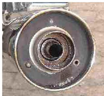
Heiß begehrt sind unsere Edelstahl-Auspuffänderungen. Der Auslass der Serierendämpfer wird von innen 20mm auf 28mm vergrößert und die Umlenkung in der letzten Kammer des Dämpfers wird umgangen. Der Sound wird deutlich dumpfer aber nur mäßig lauter. Das Fahrgeräusch erhöht sich um ca. 4 DB. Somit liegt es normalerweise innerhalb des Toleranzbereiches. Eine ABE
