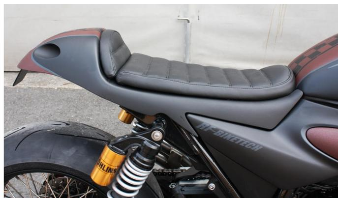
Heckverkleidung für 1 und 2-Mannbetrieb. Unter dem Soziusplatz ist ein Staufach, in dem einiges untergebracht werden kann. Für die Montage der Heckverkleidung muss das Rahmenheck gekürzt werden. Im Café Racer Heck Komplet Kit sind alle Anbauteile für die XJR enthalten.
