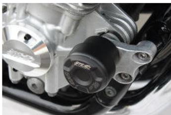
Mit diesen formschönen und perfekt verarbeiteten Sturzpads können im Falle eines Sturzes oder alleine beim Umfallen des Motorrads Schäden an Motor, Rahmen und Verkleidung verhindert oder zumindest stark eingeschränkt werden. Rechts oder links gefallen, ein Motordeckel ist immer hin! Nichts ist ärgerlicher
