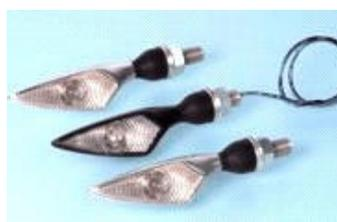
Die neueste Entwicklung aus dem Hause Kellermann sind die Micro LED White Rhombus. Die Technik basiert komplett auf den bekannten Micro LED. Sie sind ebenfalls mit LED Technik und mit klarem Glas ausgestattet. Die spitze Form unterstreicht die deutlich aggressivere Optik der Blinker. Alle Preise sind Stückpreise! Für die Verwendung dieser Blinker sind Widerstände oder ein anderes Blinkrelais erforderlich.
