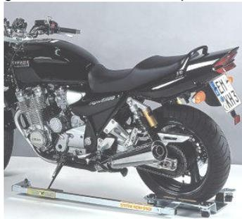
untergebracht werden. Wenn kein Hauptständer mehr montiert ist, haben wir auch die passende Lösung mit der Erweiterung um die Seitenständerschiene. Sie wird an die Rangierhilfe seitlich angeschraubt. Diese Schiene nimmt den Seitenständer auf und das Hinterrad steht auf der Rangierhilfe. Somit lässt sich das Motorrad über das Vorderrad und die Rangierhilfe schon fast
