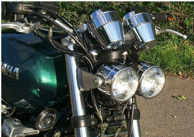
90mm Doppelscheinwerfer. mit H4 60/55Watt Birnen. Passt auch ohne Haltesatz an die originale Befestigung der XJR.
