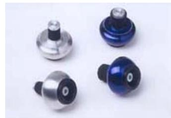
Innenteil ist aus Kunststoff, das Außenteil aus Stahl, bzw. Edelstahl. Für Stahlenker = Innendurchmesser 18mm und Alulenker = 14mm
