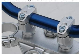
einfach auf der Seriengabelbrücke montiert werden. Sie sind lieferbar für Big-Bar Lenker mit 28,5mm Klemmung. Bei der Form der Unterteile kann gewählt werden zwischen Rund oder Rechteck (abgebildet auf dem Bild oben rechts). Als Farbvarianten stehen Alu natur, silbern oder schwarz eloxiert zur Auswahl.
