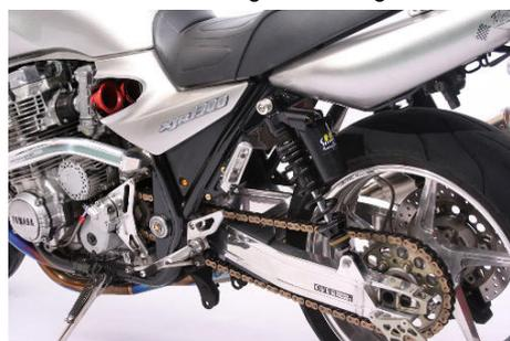
und die schwarze Feder verleihen der XJR ein super edles Aussehen! Die Dämpfer sind in der Zugstufe, der Federvorspannung und beim Typ 467 auch in der Druckstufe im High- und Low-speedbereich einstellbar. Für die XJR können wir die Federbeine mit und ohne Ausgleichsbehälter anbieten. Eine Längenverstellung ist gegen Aufpreis erhältlich.
