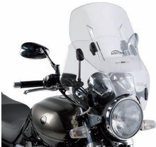
Ähnlich wie die MRA Vario Scheibe ist die Givi Airflow auch verstellbar (oberere Teil der Scheibe kann hoch und runter verschoben werden). Sie bietet zusätzlich einen deutlich besseren Windschutz. Die Scheibe wird mit Haltearmen am Lenker und an der Gabel montiert und lässt sich für jede gewünschte Position einstellen. Besserer Windschutz lässt sich bei der XJR nicht verwirklichen! Höhe von 520-640mm, Breite 530mm. ABE
