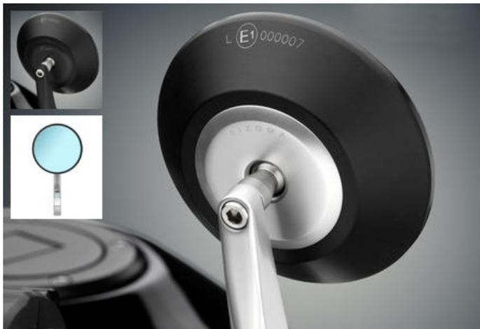
Schlicht gehalten, aber edel und wunderschön präsentiert sich der Lenkerendenspiegel Class Retro von Rizoma auf der XJR. Er kann sowohl direkt auf den Lenker aufgeschraubt werden, oder auch auf die Lenkerenden MA506 oder MA502 von Rizoma aufgeklemt werden. Die Lösung mit den Lenkerendstücken ist zu bevorzugen, da somit keine Lenkerbreite verloren geht. Die Größe des Spiegelglases ist optimal an die Norm angepasst, somit hat dieser Spiegel auch eine ABE. Stückpreis.
