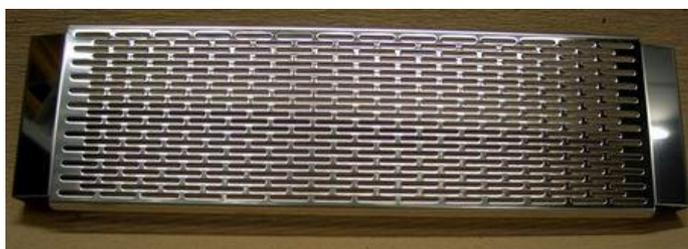
Dieser Kühlergrill ist etwas filigraner gearbeitet als der Kühlergrill I. Er hat schmalere Schlitze und bietet daher auch eine höhere Luftdurchlässigkeit. Der Grill wird unter den Serienblenden montiert und deckt nur die vordere Kühlerfläche ab.
