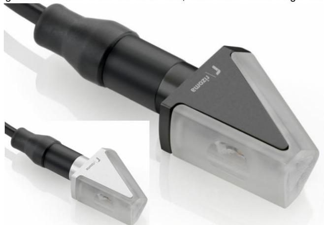
dass man nicht gesehen wird. Die Blinker können an die XJR problemlos angebaut werden. Erforderliche Widerstände sind im Lieferumfang enthalten. Wir empfehlen unser elektronisches Blinkerrelais, um die Verwendung von Widerständen überflüssig zu machen, die ansonsten irgendwo im Fahrzeug versteckt werden müssten. Lieferbare Farben: AVIO21 (Bild oben) sind in silber, gold, rot, schwarz lieferbar. Zero, (Bild Mitte) in silber und schwarz. Club / Club S (Bild unten) sind
