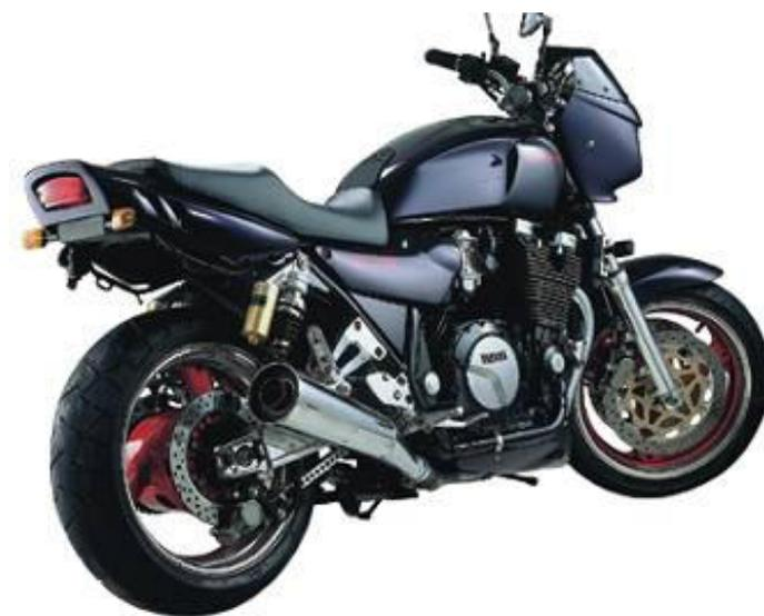
Diese XJR ist mit einer anderen Heckverkleidung, Lampenverkleidung Typ Hesa 1 und einem kleinen Bugspoiler ausgestattet. Bei dieser Heckverkleidung bleibt die originale Sitzbank erhalten, lediglich die Heckverkleidung wird verändert. Für die Montage muss, wie auch bei der RG 5 Verkleidung, der Heckrahmen gekürzt werden. Mit TÜV.
