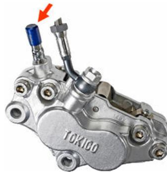
Diese patentierten Stahlbus Bremsenentlüftungsventile sind ein geniales Ergebnis deutscher Ingenieurskunst! Mit diesen Ventilen lässt sich die Bremsanlage spielend leicht entlüften, denn das Sicherheitsventil in der Entlüftungsschraube verhindert das beim Aufdrehen der Entlüfter Luft in das System eindringen kann. Somit ist es nicht mehr notwendig den Nippel ständig auf und zu zu drehen, sondern man
