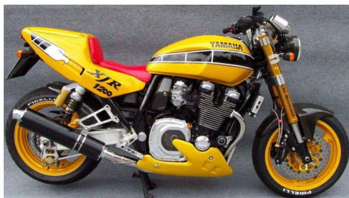
Heckverkleidung für 1 und 2-Mannbetrieb. Unter dem Soziusplatz ist ein Staufach, in dem einiges untergebracht werden kann. Für die Montage der Heckverkleidung muss das Rahmenheck gekürzt werden. Mit TÜV.
